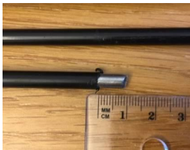
Bild 15: Avskalning av nivågivarna.
