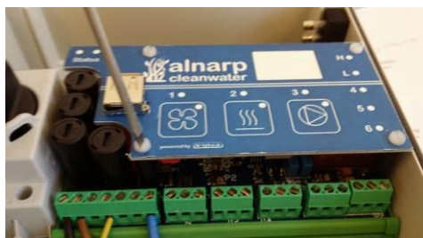
Bild 13 skruva bort displaykortet
