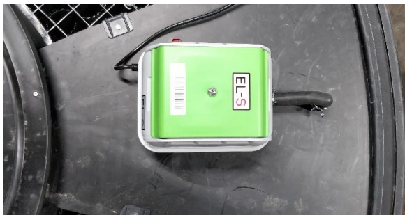
Bild 10: Luftpumpens placering på InterACT
