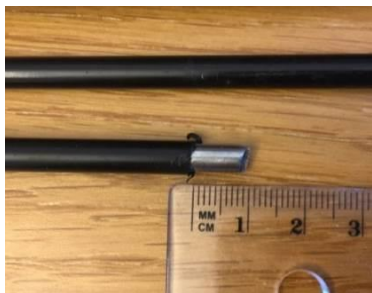
Bild 15: Avskalning av nivågivarna.
