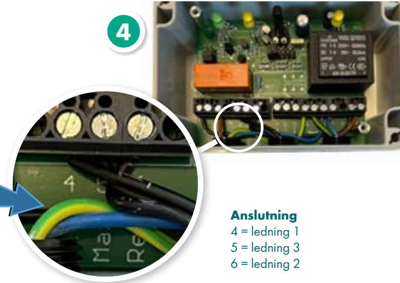
Ta bort glas och platta: Observera att klämmorna 4, 5, 6 ska användas.
